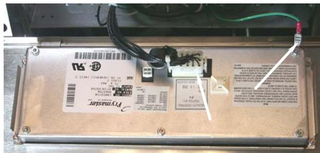
Si vous remplacez le contrôleur, débranchez le fil de terre et le connecteur à 15 broches (flèches).
