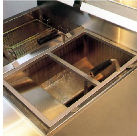
5. Une fois l'huile filtrée, fermez le robinet de vidange et laissez la friteuse se remplir. Lorsque des bulles apparaissent dans l'huile, laissez fonctionner le filtre pendant 10 à 12 secondes de plus pour déboucher les conduites et empêcher la graisse de durcir à l'intérieur, puis **POUSSEZ** la poignée du filtre sur position Arrêt (flèche).
