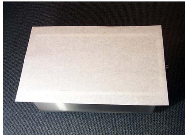
5. Positionnez l'anneau de maintien sur le filtre en papier et abaissez-le dans le bac pour permettre au papier de se replier autour lorsqu'il est poussé au fond du bac.
